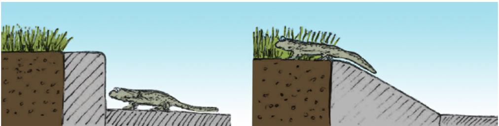
Figure 4 : pose des bordures en retrait des avaloirs. Modifié d'après Percsy (2005).
