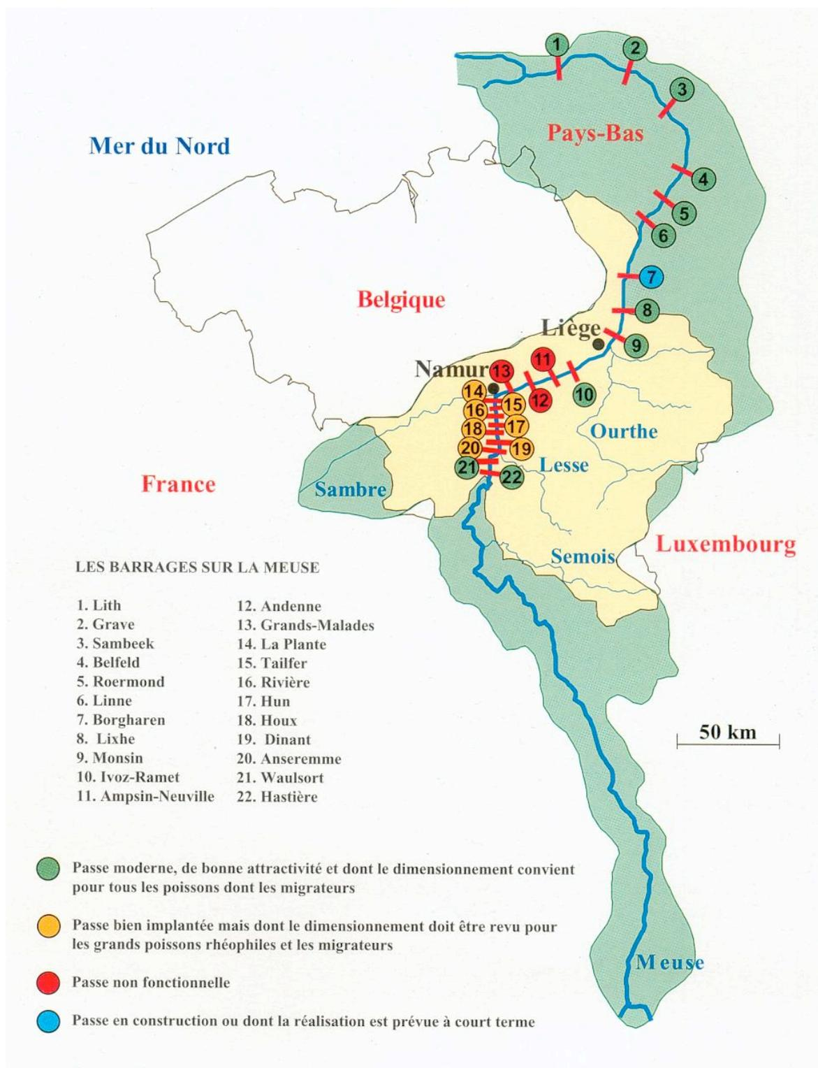
**Figure 72.** Etat d'avancement en 2006 de l'équipement en échelles à poissons modernes des barrages sur l'axe Meuse entre la mer du Nord et la France( MRW, brochure sous presse).
