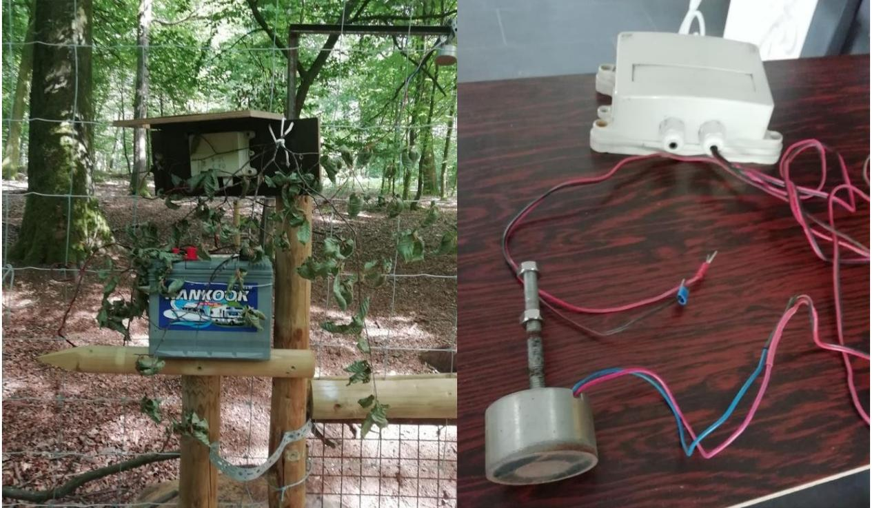
Figures 10 et 11 – A gauche : le système de déclenchement à distance installé sur le terrain (batterie, boîtier et aimant). A droite : le boîtier chargé de rompre à distance le courant et donc le champ magnétique de l'aimant
