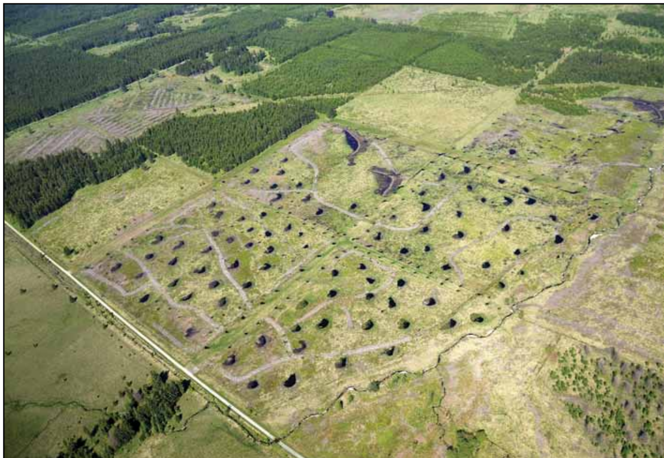
Nombreux bassins réalisés après déboisement des pessières dans la vallée supérieure de la Soor, notamment en colmatant les drains. En bas à gauche, la route dite du « Grand Fossé ». (Photo A. Drèze, mai 2012).
